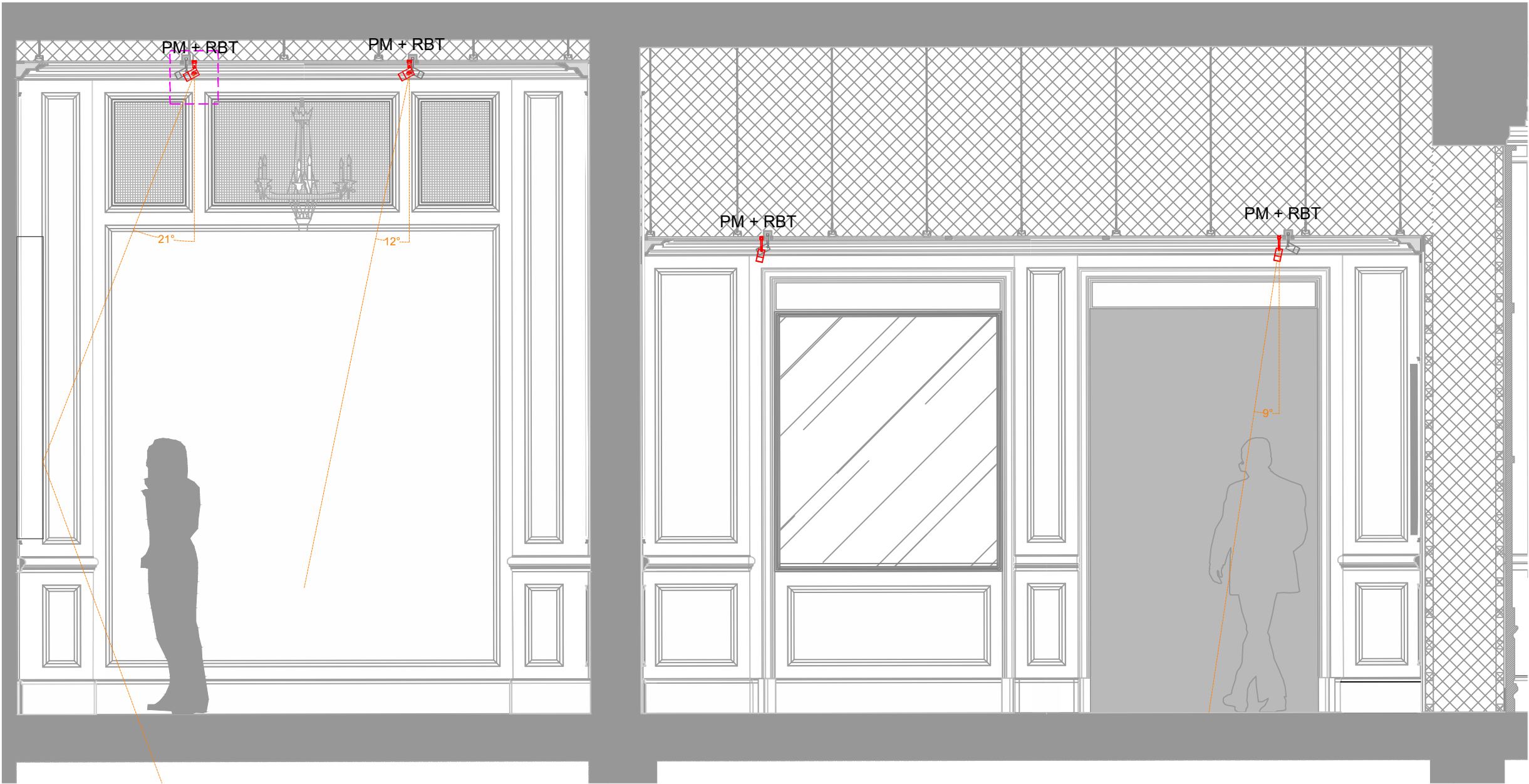
Inclinaison du projecteur et zone de reflet g n r   ch : 1/30
